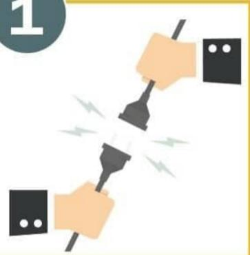
Висмикніть вилку приладу з розетки, вимкніть струм рубильником, відтягніть дріт дерев'яною палицею
